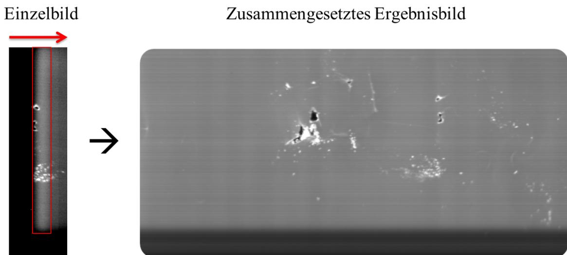
**Abb. 7.** Partikeldetektion mit Laseranregung entlang einer Linie (Prüfkonzept siehe Abbildung 2). Aus hunderten Einzelbildern (links) wird jeweils eine vertikale Linie entnommen und zu einem Ergebnisbild zusammengesetzt (rechts).
